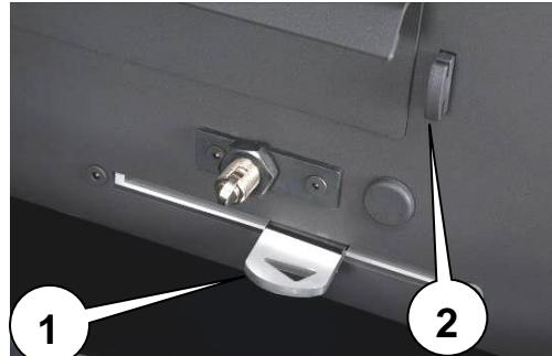
**Primární Регулятор первичного** воздуха используется для регулирования подачи снизу воздуха для горения, который поступает через зольник и колосниковую решетку к топливу. В этой связи следует избегать переполнения зольника, поскольку зола может заблокировать доступ воздуха в топку.
