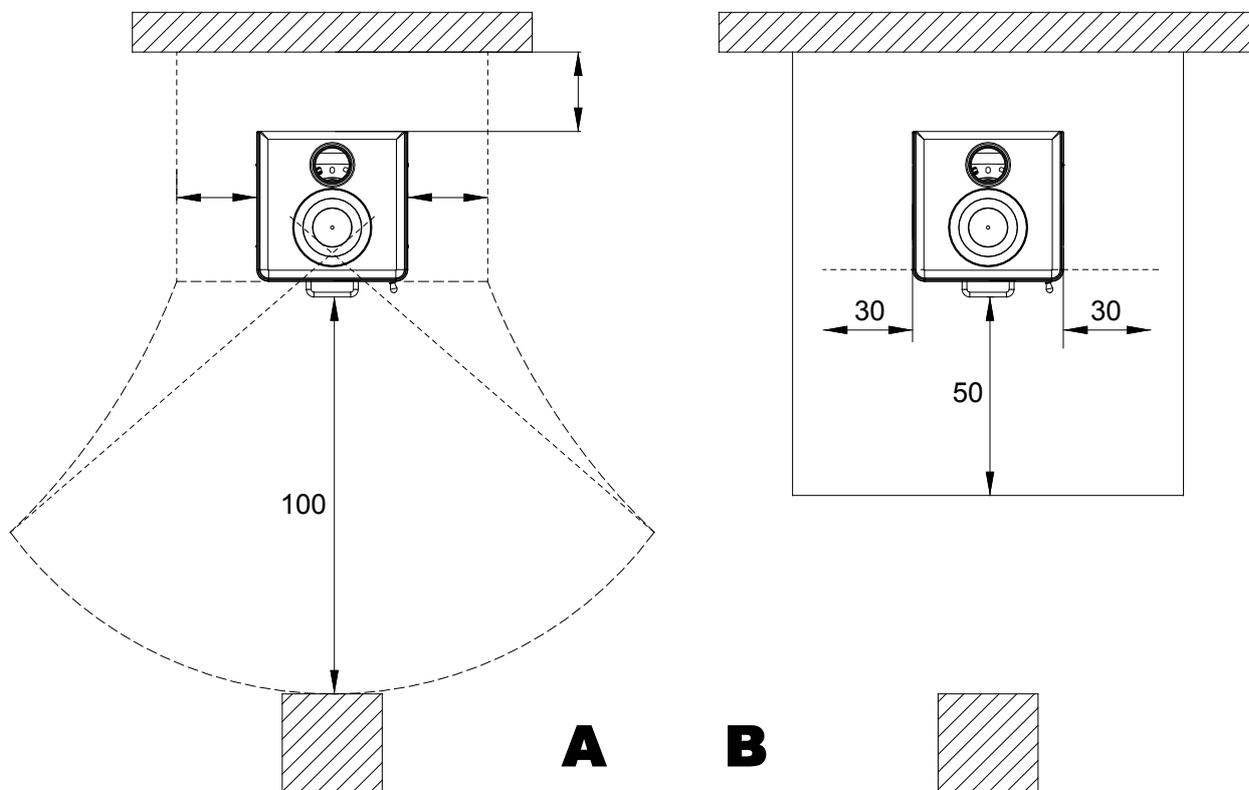
Všechny minimální bezpečné vzdálenosti (cm) jsou uvedeny na typovém štítku výrobku a NESMÍ se klesnout pod stanovené hodnoty (viz **PROHLÁŠENÍ O VÝKONU - INFORMACE OZNAČENÍ CE**).
