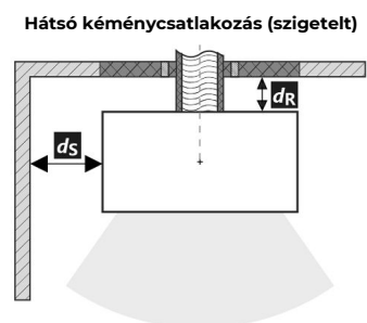
A füstcső áthaladása éghető anyagból készült falon
