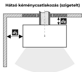
A füstcső áthaladása éghető anyagból készült falon
