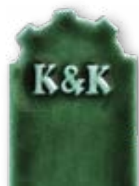
MX 100, 0% Vltavín, lesklá, průhledná, viditelný haarriss
